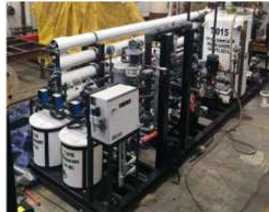
Estos sistemas de ósmosis inversa se entregan totalmente ensamblados y con pruebas en fábrica. Montados sobre patín para así minimizar el trabajo en campo y agilizar su puesta en marcha.
